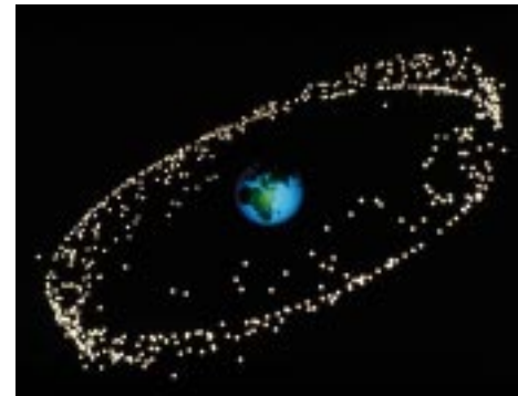
↑ De geostationaire baan is bijzonder geschikt voor weer-satellieten en kunstmanen voor telecommunicatie en televisie. In deze voorstelling van de verdeling van objecten in deze zone zijn gemakkelijk de niet meer operationele satellieten te herkennen, die zich in een kerkhofbaan 300 km boven de geostationaire baan bevinden. In de loop der jaren hebben deze op zichzelf aangewezen satellieten de neiging zich te concentreren ten noorden en ten zuiden van de ring. Foto ESA
