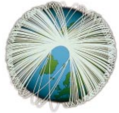
↑ De fragmentatie van de bovenste trap van een raket of een satelliet in een lage baan om de aarde veroorzaakt in een klap veel nieuwe brokstukken. Deze simulatie toont dat in de loop van de drie jaar volgend op deze explosie de baanvlakken van de brokstukken evolueren en uiteindelijk bijna heel de planeet bestrijken. Foto ESA
